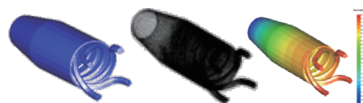
スパイラルダイの三次元熱流動解析 (テトラ要素) Flow Tetra
