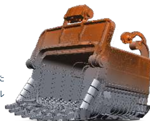
Geomagic Design X で作成した パラメトリックソリッドモデル
